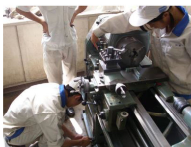
図11 レベル調整作業風景
