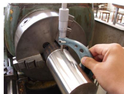
図12 機械の精度検査
