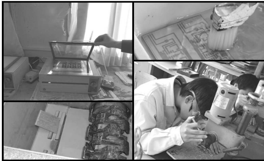
写真7 電子回路製作工程（左上：露光、右上：現像、左下：エッチング、右下：ドリリング）
