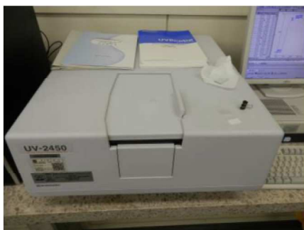
図10 可視紫外分光光度計
