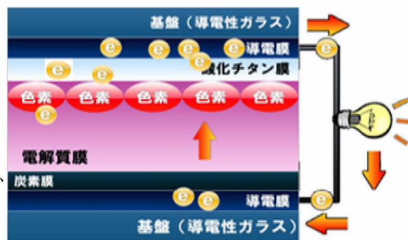
図1 色素増感太陽電池の原理図
