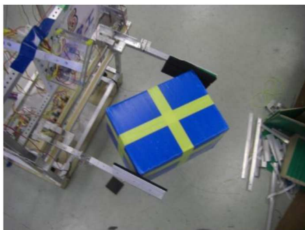
写真7 箱の斜め掴み
