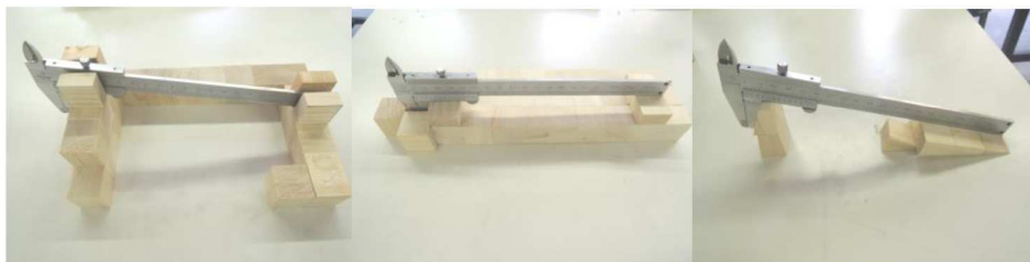
図8 ノギスの並べ方を考えるための試作品
