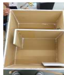
図8 ダブルバスレフ構造
